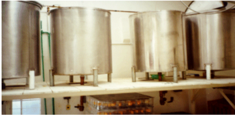
Foto 5. Tanques de sedimentación en Acero Inoxidable (Cortesía de Miel Abarca).
