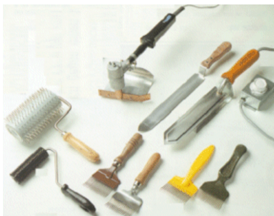
Foto 2. Desoperculadores: A) Cuchillo de calentamiento, B) Cuchillo eléctrico, C) Tenedores D) Rodillos.
