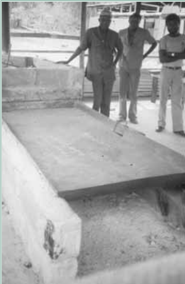
FIGURA 15 Máquina grande de prensa plana para producir gari a escala rural en Nigeria.
