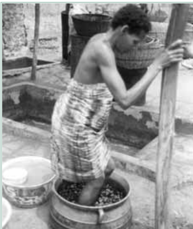
FIGURA 7 Amasado tradicional de frutos de palmera de aceite luego de la cocción al vapor para producir aceite que se utilizará en una localidad de Benín.
