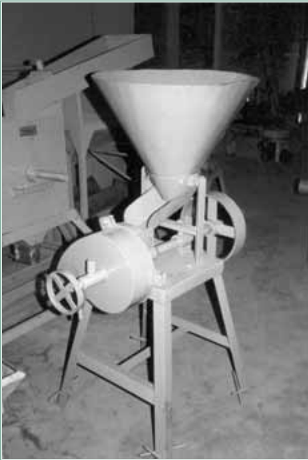
FIGURA 13 Molino de discos verticales de fabricación local en Nigeria, utilizado para productos húmedos y secos.
