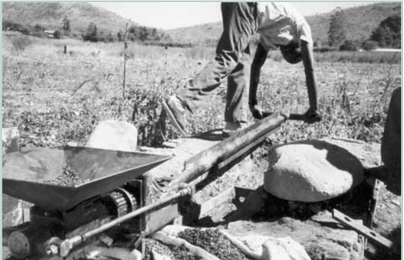
FIGURA 6 Prensa de palanca Bielenberg que extrae aceite a partir de semillas de girasol híbrido en Zimbabwe.
