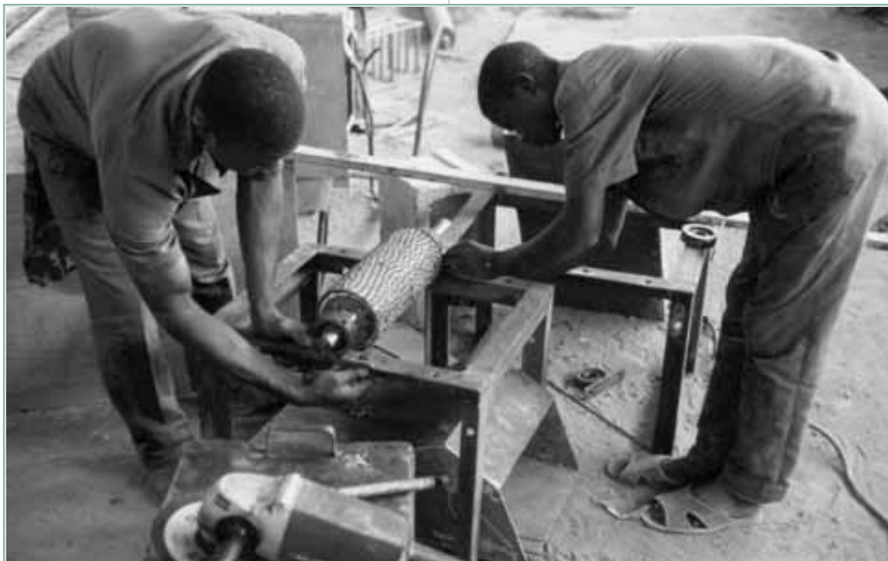
FIGURA 16 Taller rural en Nigeria donde se fabrican raspadores de yuca.
